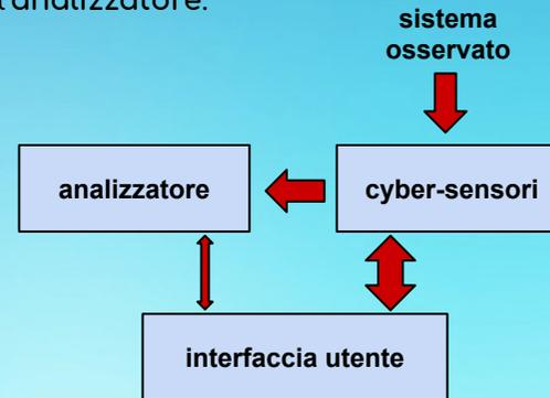
I "cyber-sensori", cioè macchine su cui sono in esecuzione i software di IDS / IPS, agiscono direttamente sul sistema osservato. Essi monitorano il traffico, analizzano la rete e riferiscono le statistiche misurate all'analizzatore.
